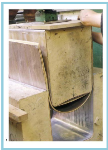
Εικόνα 6: Διαδικασία Καμπύλωσης Ξυλοφύλλων (Veneer Lamination), από το βιβλίο «Manufacturing Processes for Design Professionals»
