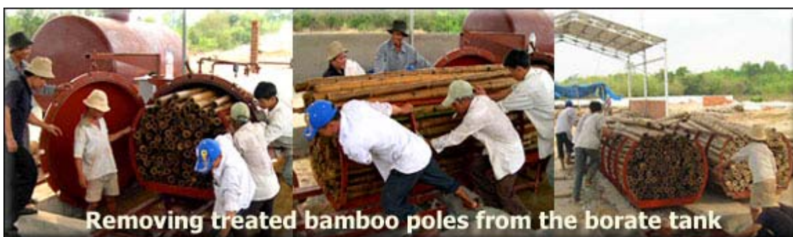
β) Εμποτισμός σε κενό υπό πίεση με υδατοδιαλυτά άλατα βορίου.
