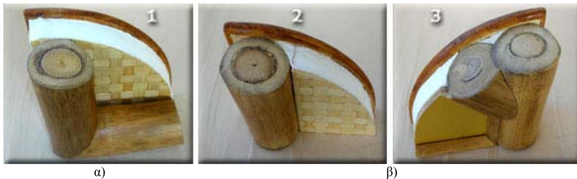
Εικ. 40. Τοιχοποιία κατοικίας από μπαμπού α) το πάνελ τοιχοποιίας 3 στρώσεων στερεώνεται έξω από τους ορθοστάτες μπαμπού, β) οι ορθοστάτες εσωκλείονται στο πάνελ τοιχοποιίας.
