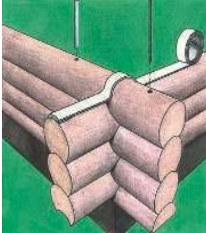
Εικ. 24. Στρόγγυλοι κορμοί με εγκοπή στο κάτω μέρος για την καλύτερη μεταξύ τους σύνδεση.
