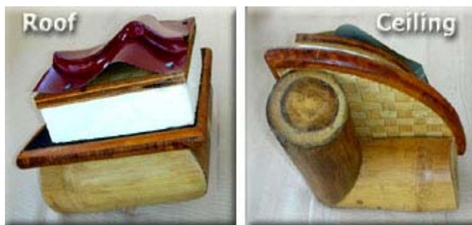
Εικ. 39. Κατασκευαστικό σάντουιτς στέγης (α) από μπαμπού με μόνωση και κόντρα πλακέ και ταβανιού (β).
