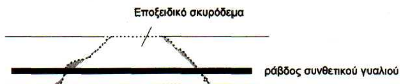
Σχήμα 30. Επισκευή φθαρμένης δοκού με εποξειδικό σκυρόδεμα και ράβδο συνθετικού γυαλιού.
