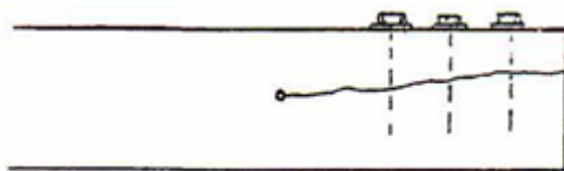
Σχήμα 31. α) Διάτρηση άκρου της ρωγμής και σύσφιξη περιοχής ρηγματώσεως και β) περιοχής ευάλωτης στη ρηγμάτωση (β).
