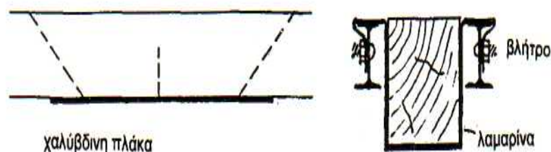
Σχήμα 23. Ενίσχυση ξύλινου δομικού στοιχείου.
