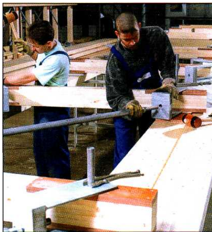
Εικ. 5. Εφαρμογή του Lignostone στην ενίσχυση συνδέσεων ζευκτών στέγης μεγάλων ανοιγμάτων.
