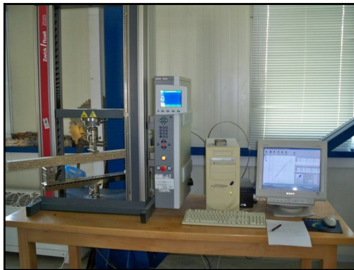
Φωτογραφία 5. Μηχανή δοκιμών για τον προσδιορισμό της αντοχής σε κάμψη.
