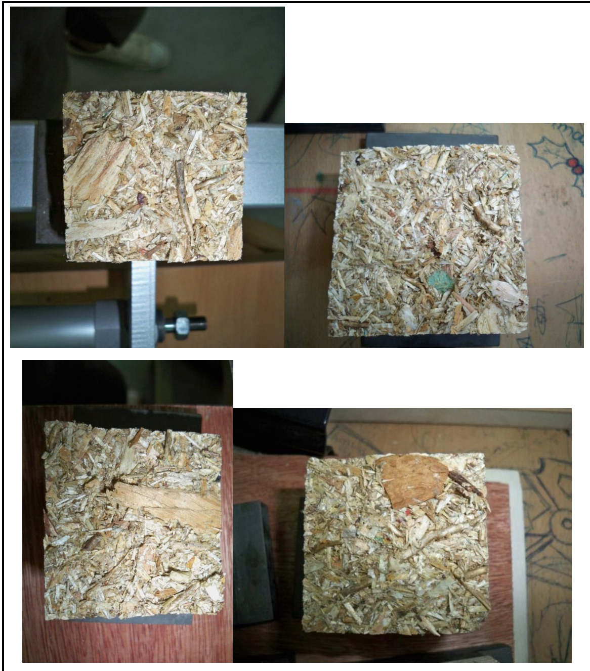
Φωτογραφία 9. Δοκίμια σχισμένα ύστερα από τεστ αντοχής σε εγκάρσιο εφελκυσμό, στα συγκεκριμένα δοκίμια βρέθηκαν ξένα σώματα (κομμάτια χαρτιού, κομμάτια ξύλου και φλοιούς από καρύδια) στο εσωτερικό τους.
