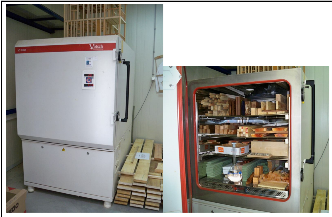
Φωτογραφία 4. Θάλαμος κλιματισμού.
