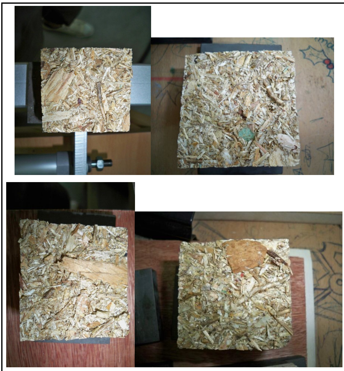
Φωτογραφία 21. Δοκίμια σχισμένα ύστερα από τεστ αντοχής σε εγκάρσιο εφελκυσμό, στα συγκεκριμένα δοκίμια βρέθηκαν ξένα σώματα (κομμάτια χαρτιού, κομμάτια ξύλου και φλοιούς από καρύδια) στο εσωτερικό τους.
