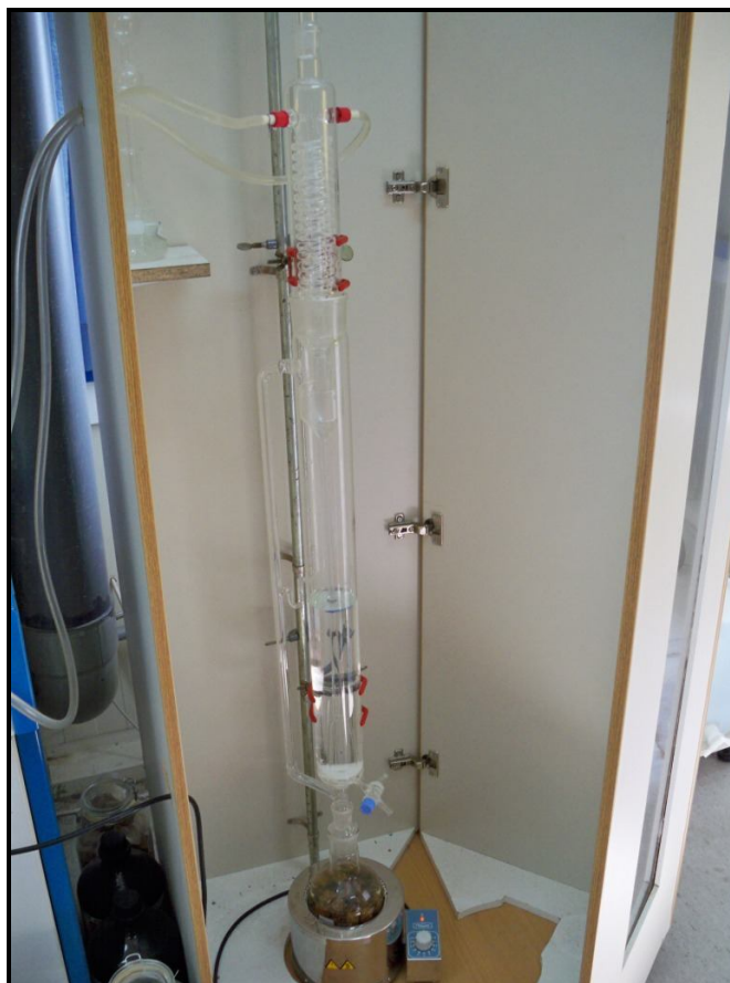
Φωτογραφία 15. Συσκευή μέτρησης των περιεχόμενων ποσοστών φορμαλδεΐδης συγκολλημένων προϊόντων με τη μέθοδο Perforator.
