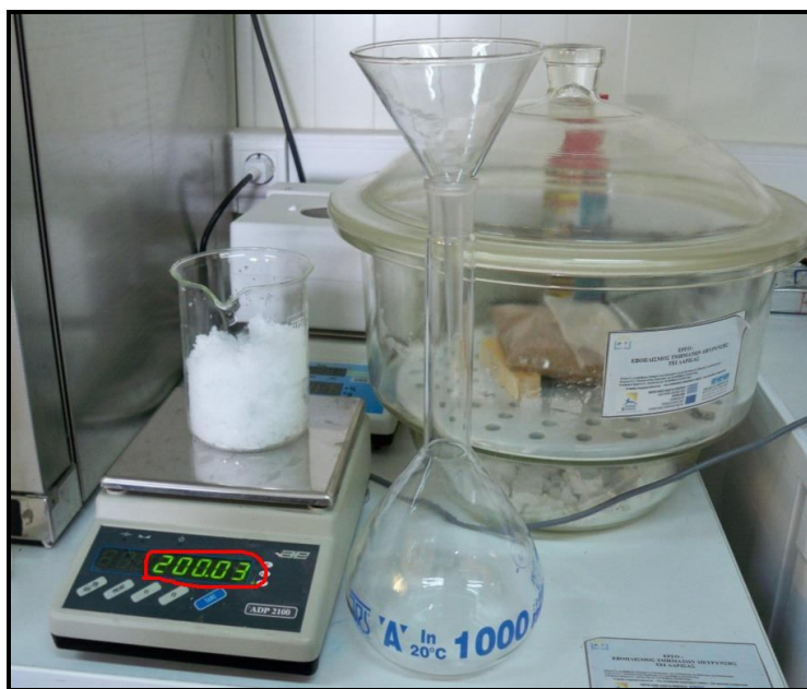
Φωτογραφία 17. Διαδικασία παρασκευής Ammonium acetate διαλύματος.
