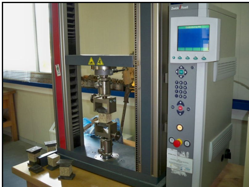
Φωτογραφία 8. Πείραμα προσδιορισμού αντοχής σε εγκάρσιο εφελκυσμό.
