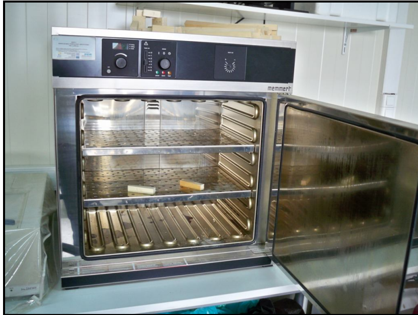
Φωτογραφία 12. Πυριατήριο (ή φούρνος) για την επίτευξη απόλυτα ξηρού βάρους.
