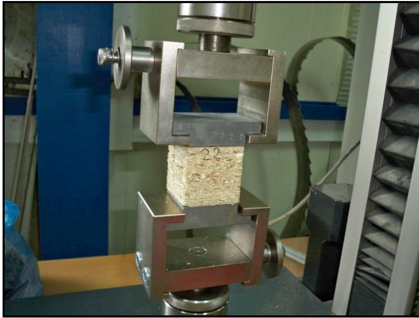
Φωτογραφία 7. Δοκίμο επικολλημένο σε μεταλλικές πλάκες.
