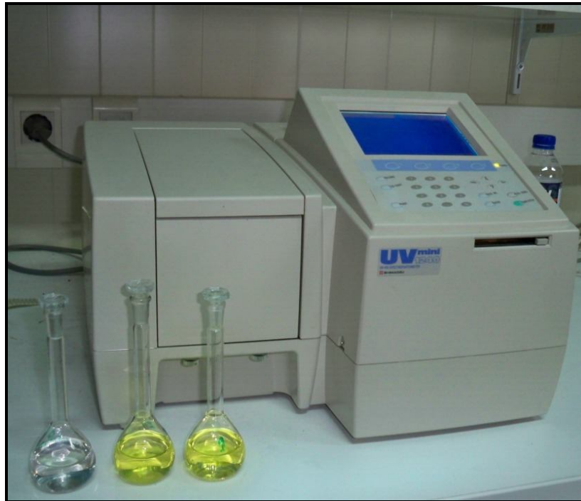
Φωτογραφία 20. Φασματοφωτόμετρο για τη μέτρηση της απορρόφησης του διαλύματος.
