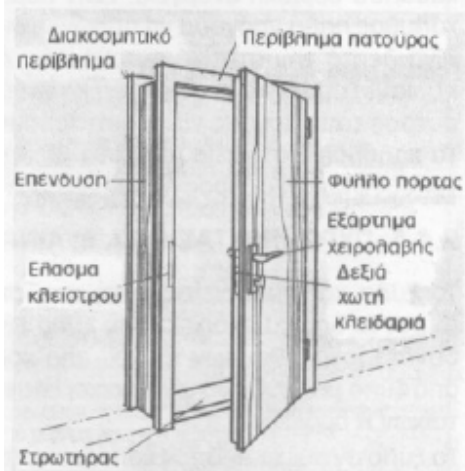
Σχήμα 2. Τα μέρη μιας πόρτας με επένδυση και περιμβήματα.
