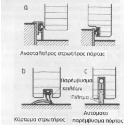
Σχήμα 2. Μόνωση στην κάτω ακμή πόρτας
