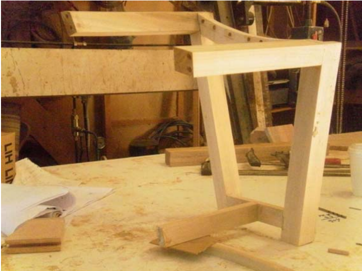
Εικ.22. Τοποθέτηση οριζόντιων τραβέρσων.
