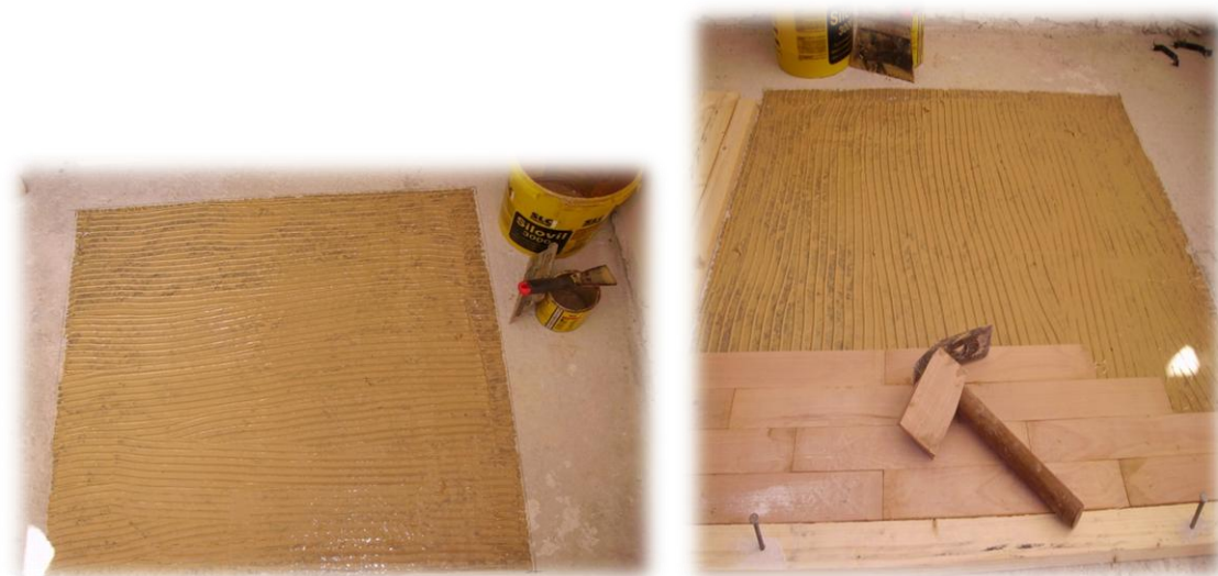
Εικόνα 43. Κατασκευή κολλητού δείγματος
