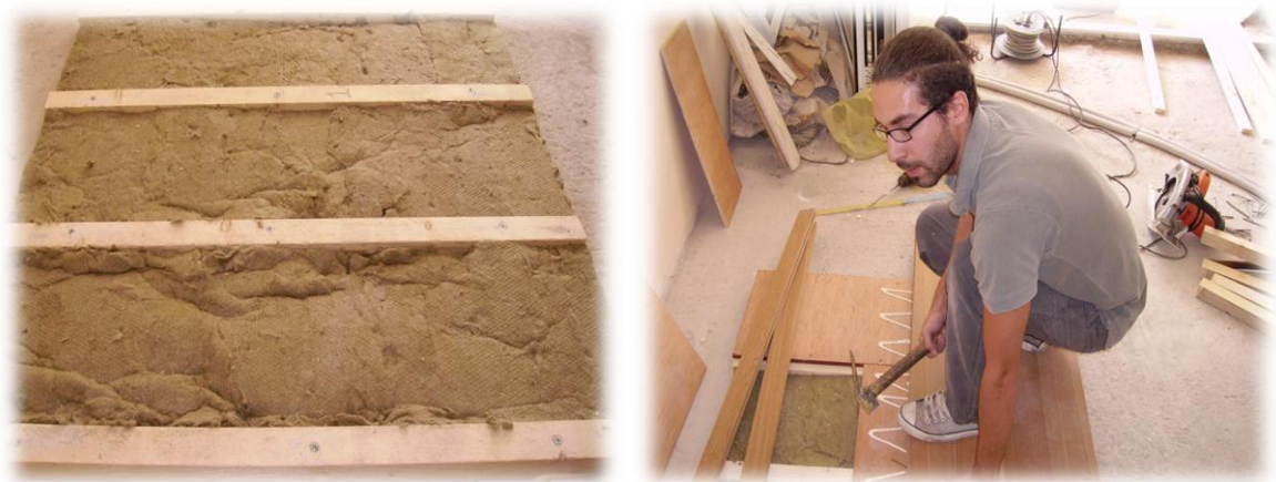
Εικόνα 41. Κατασκευή ενισχυμένου καρφωτού δείγματος.
