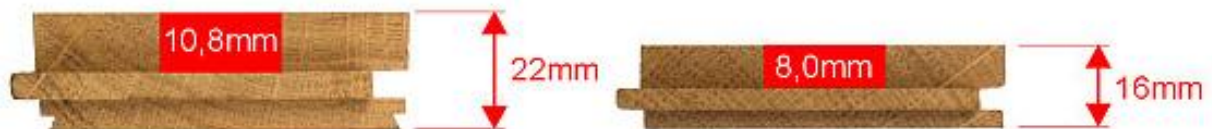
Εικόνα 2. Συνολικό και ωφέλιμο πάχος συμπαγούς παρκέτου, σε παρκέτα διαφορετικού πάχους 25 .
