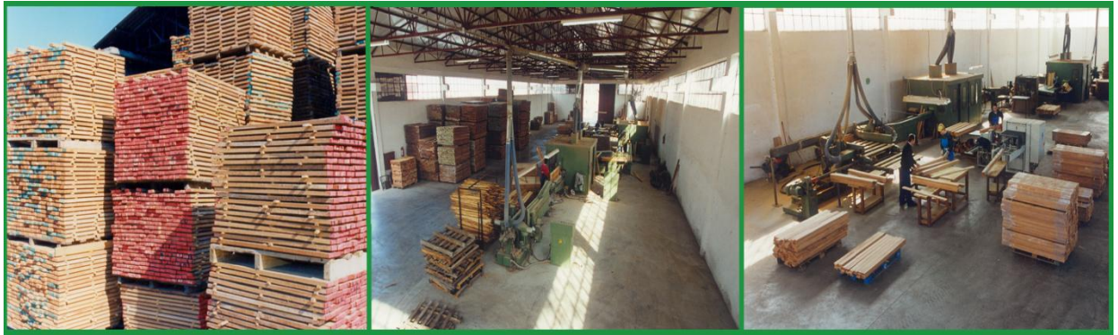
Εικόνα 5. Βιομηχανική μονάδα παραγωγής ξύλινων δαπέδων της εταιρείας Ρουσσέτος Α.Ε. Διακρίνεται το στάδιο φυσικής ξήρανσης, και οι γραμμές παραγωγής παρκέτων.
