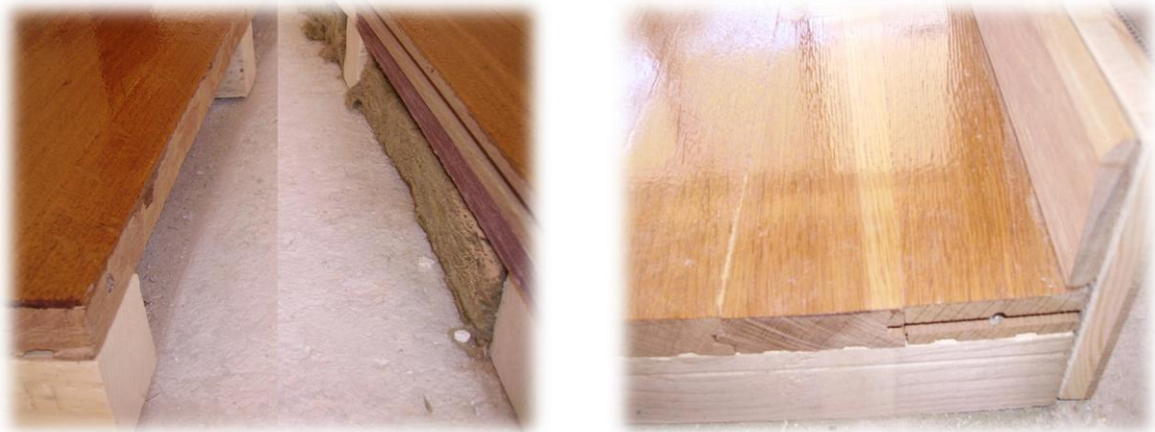
Εικόνα 42. Κάλυψη πλευρικών ανοιγμάτων στα καρφωτά δείγματα.
