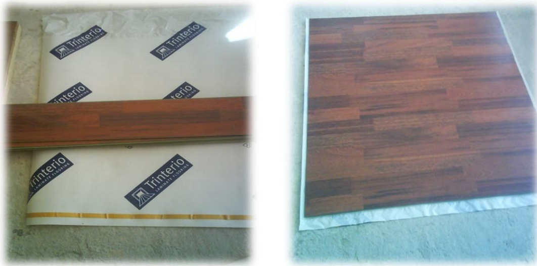
Εικόνα 44. Κατασκευή δείγματος τύπου laminate
